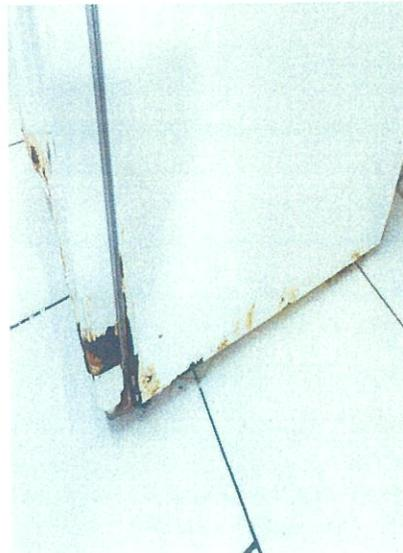
**Refrigerador com ferrugem na parte inferior frontal e lateral;**
