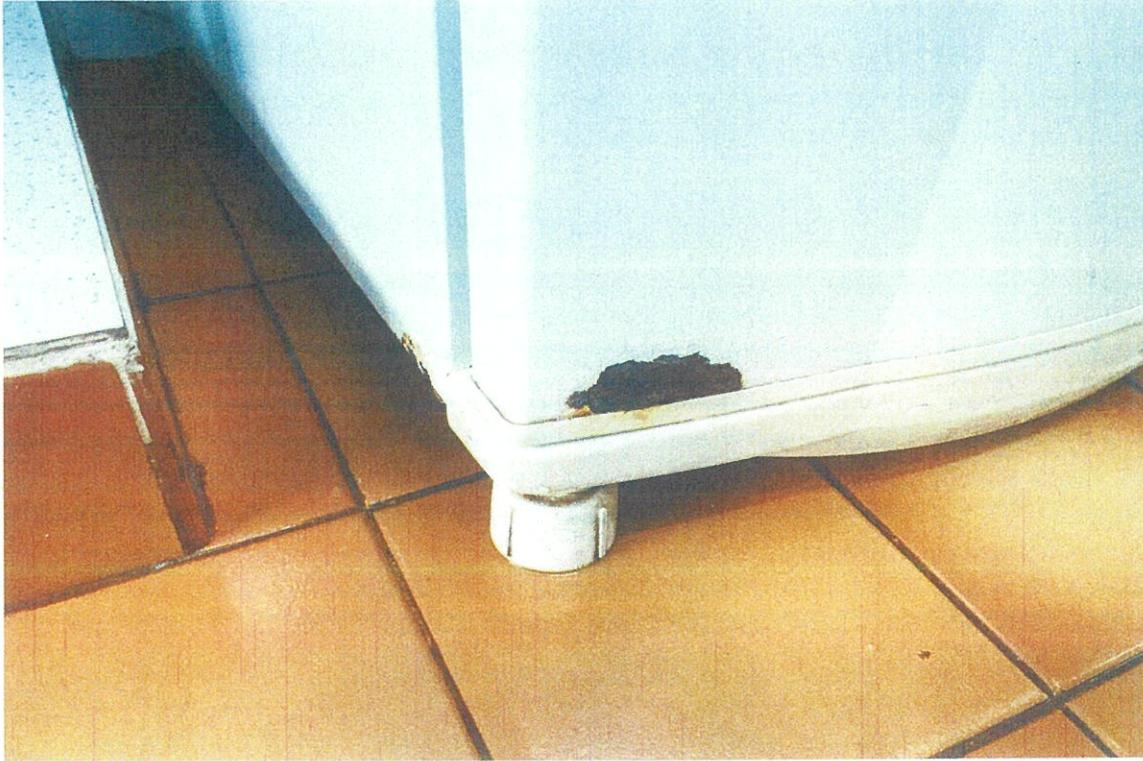
**Refrigerador 2 com ferrugem na parte inferior do equipamento;**
