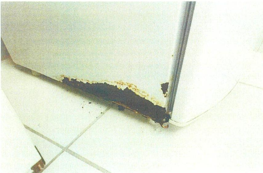
**Refrigerador 1 com ferrugem na parte inferior do equipamento;**
